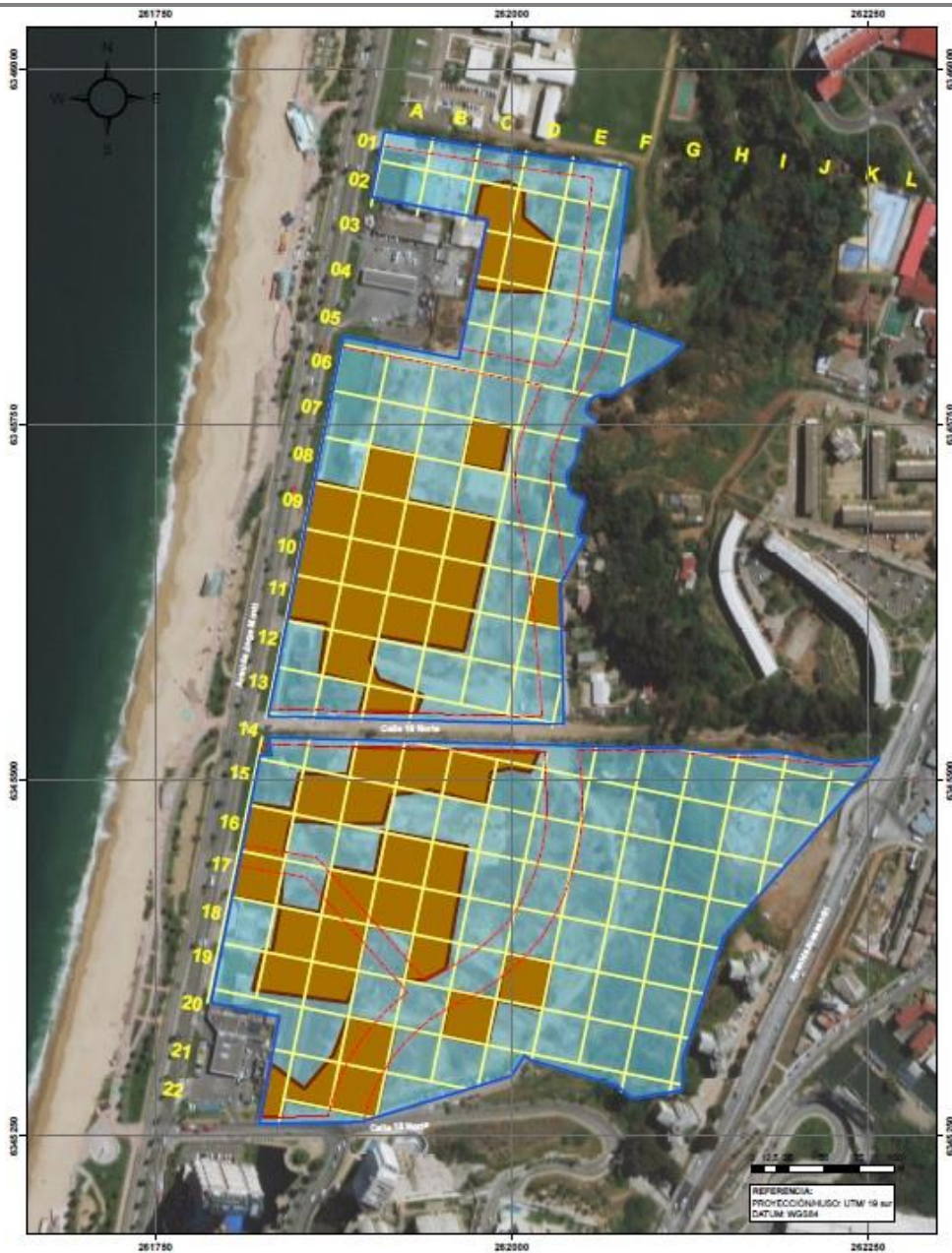
Excedencia de SSCL en el suelo para el escenario residencial. Fuente: EIA, Figura 7-2.
