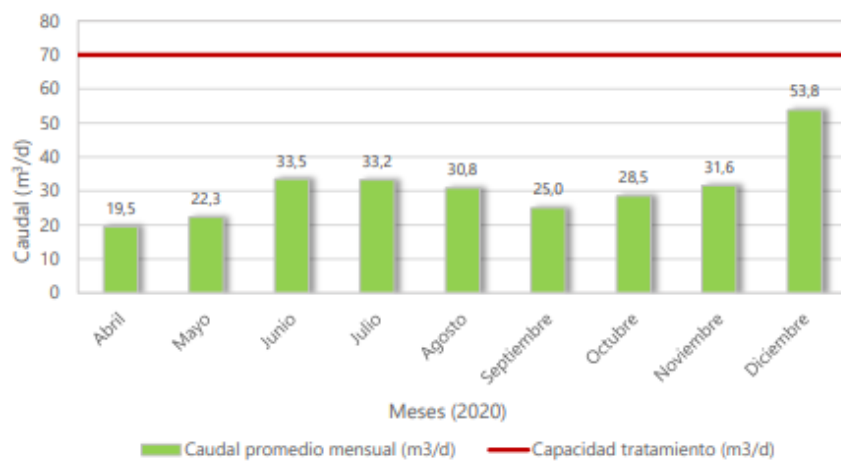
Fuente: FIGURA AD-2: Generación de Riles vs Capacidad de tratamiento, de la Adenda.
