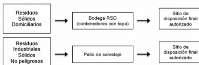
Figura N° 2.4.1. Diagrama de flujo acopio temporal y disposición final de residuos
