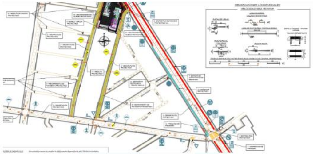
Figura N°2: Extracto plano de diseños de accesos y medidas de mitigación EISTU aprobado. Ensanche Av. Macul.
