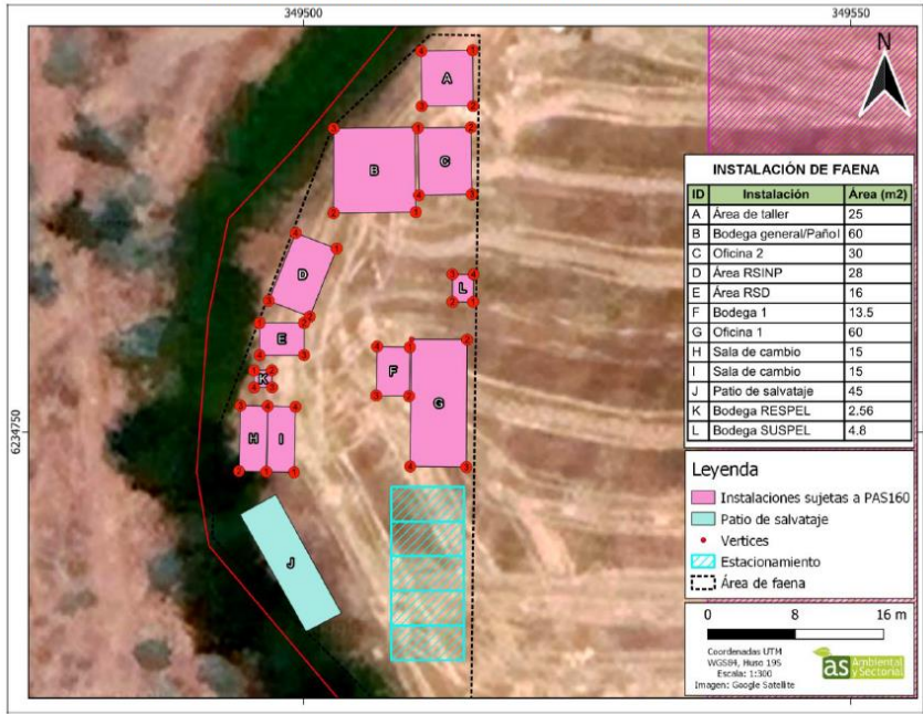
Figura 1-5: Principales partes y obras temporales del Proyecto
