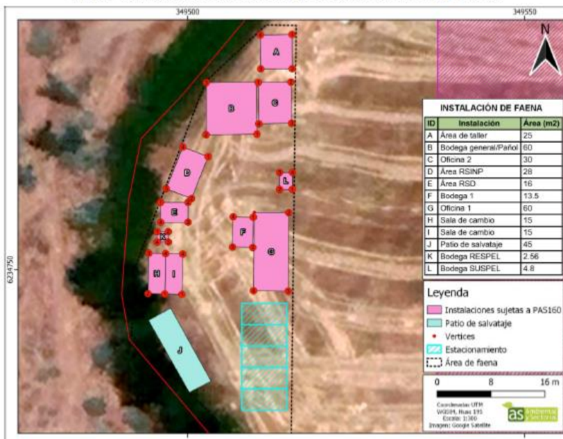
Figura 1: Instalación de faena del Proyecto (edificaciones temporales).
