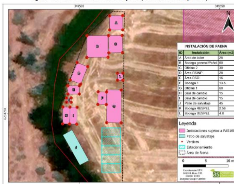
Figura 1: Instalación de faena del Proyecto (edificaciones temporales).
