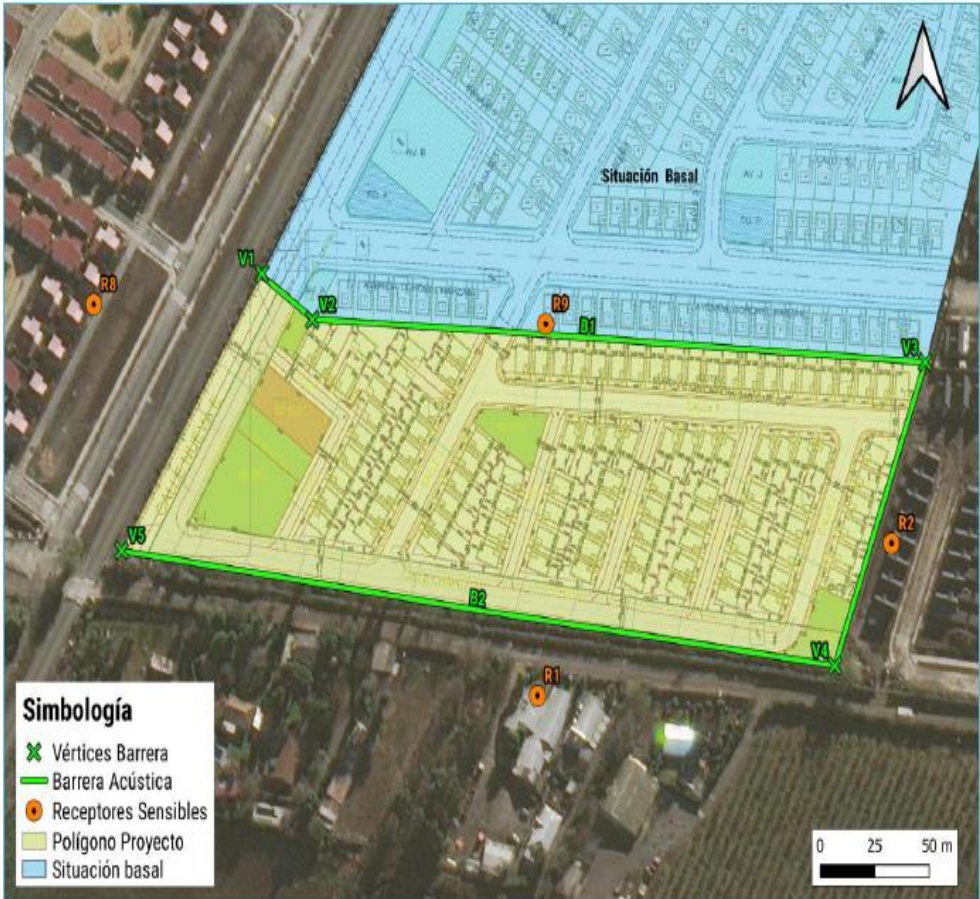
Figura 40: Barreras acústicas para fase de construcción – Lote C.
