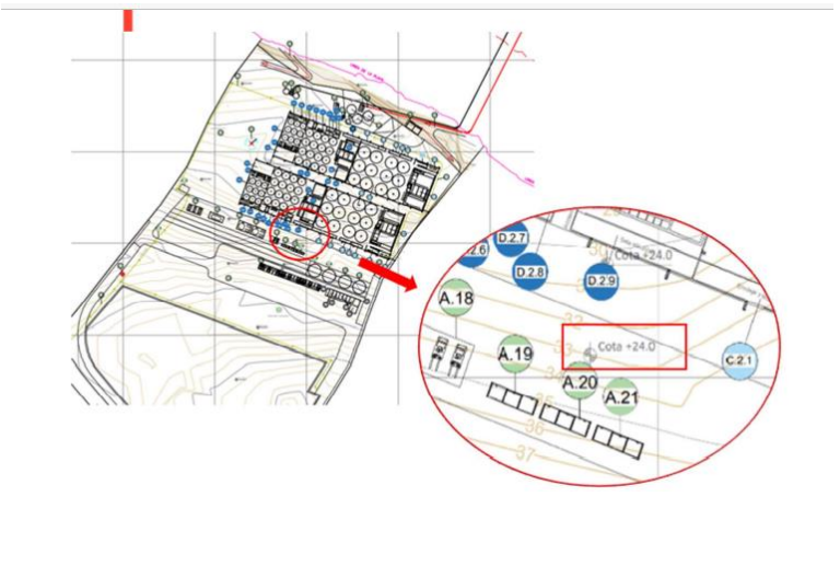
Fig. 9: Zona donde se contempla la mayor excavación en el terreno.
