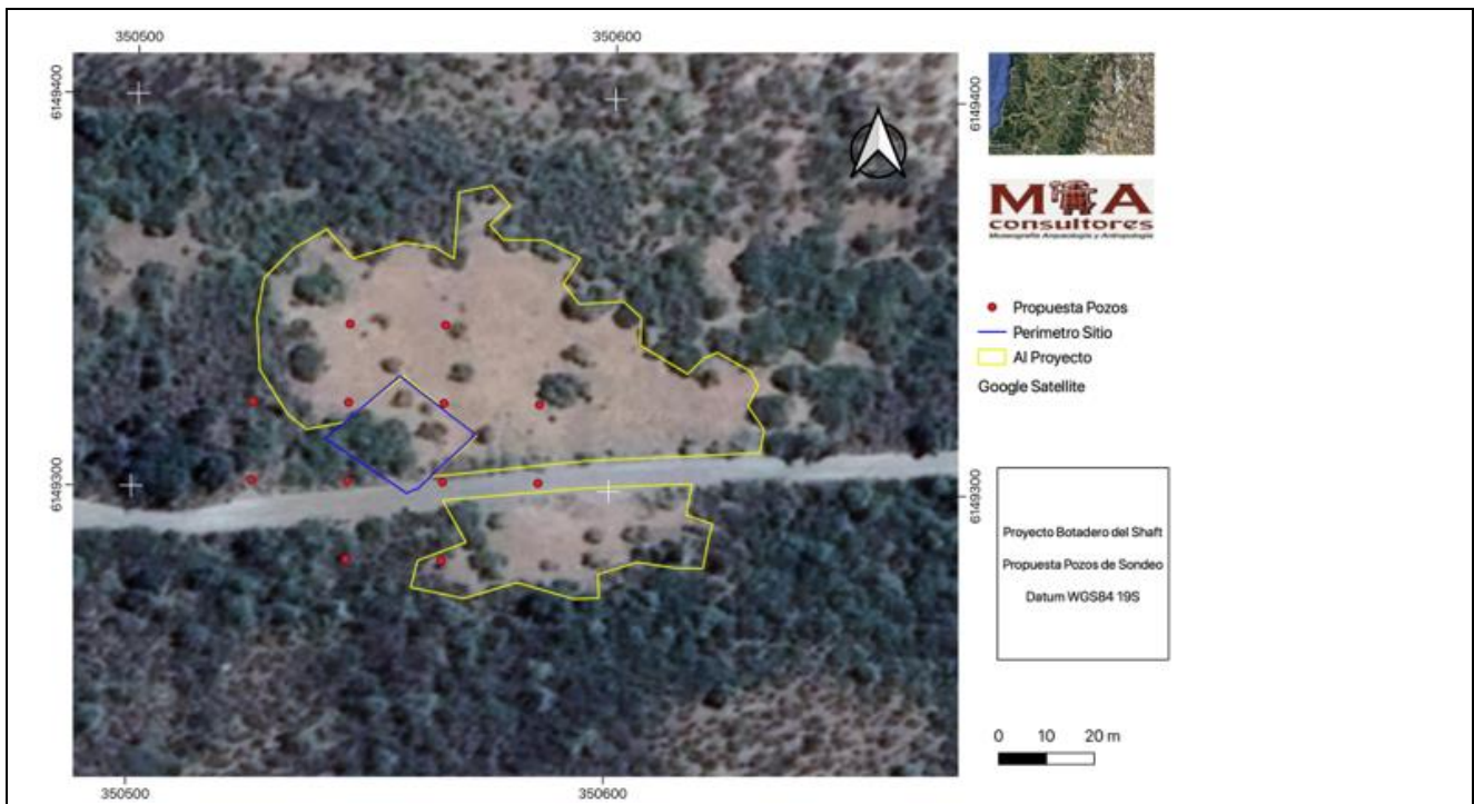
Figura 4-10: Propuesta de ubicación de pozos de sondeo
