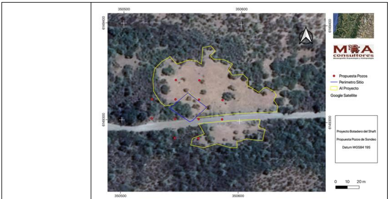
Figura 4-10: Propuesta de ubicación de pozos de sondeo
