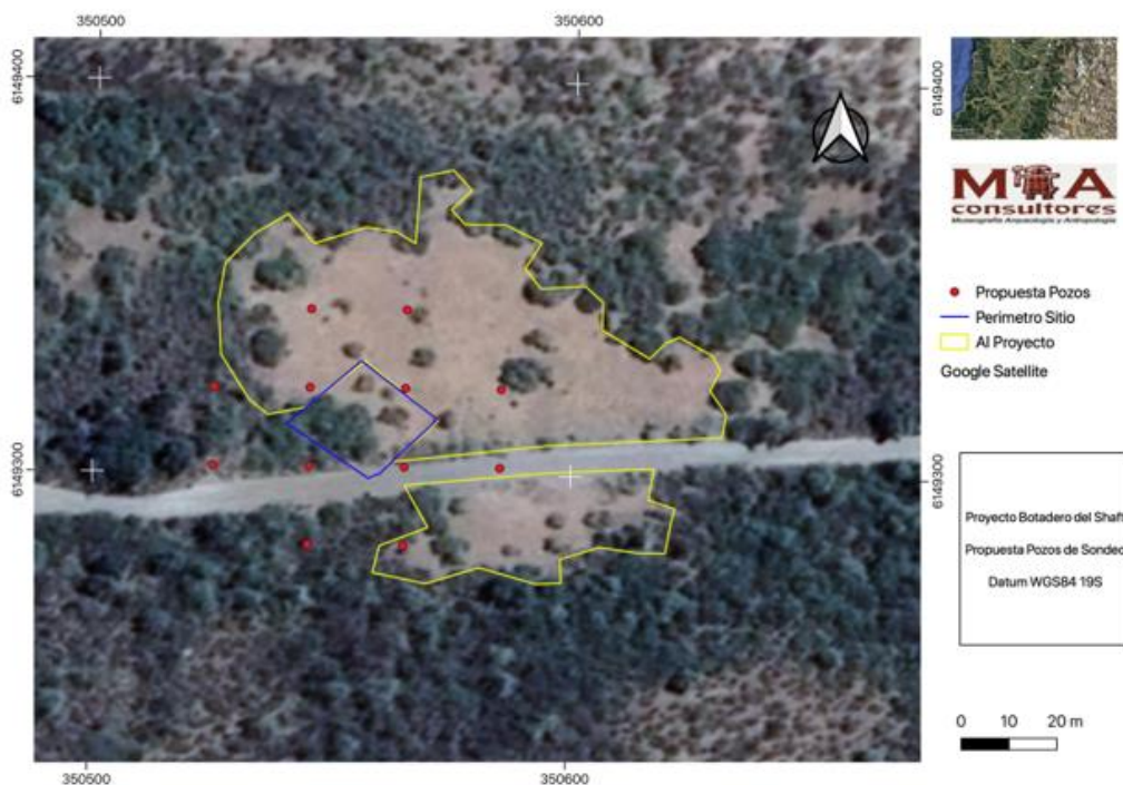
Figura 4-10: Propuesta de ubicación de pozos de sondeo
