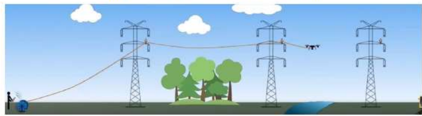
Figura 4: Tendido de cable guía con tecnología dron
