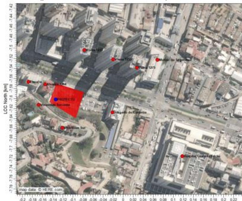
Figura 4.6.4.1.1: Distribución de los receptores discretos.
