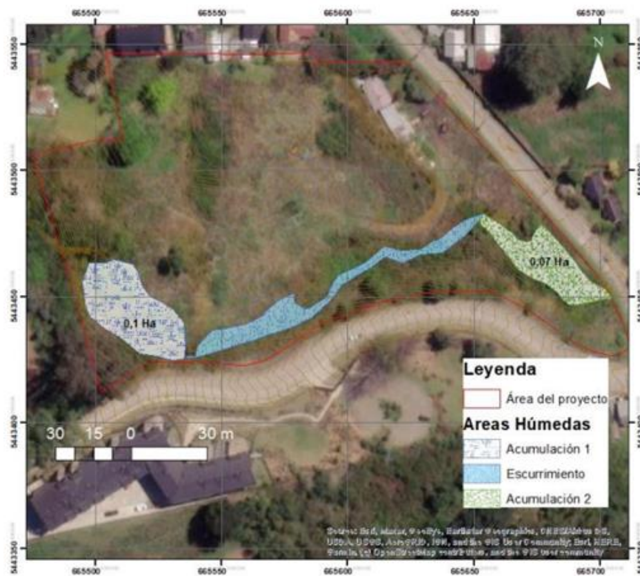
Figura 34 Sectores con características puntuales de hidrología y suelos hídricos
