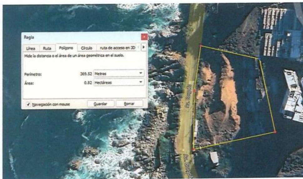
Imagen 4: Superficie intervenida, excavación y remoción de sustrato Dunar.
