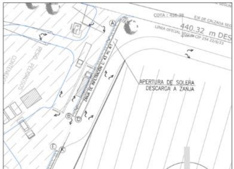
Figura 3. Zanja de infiltración con vértices.
