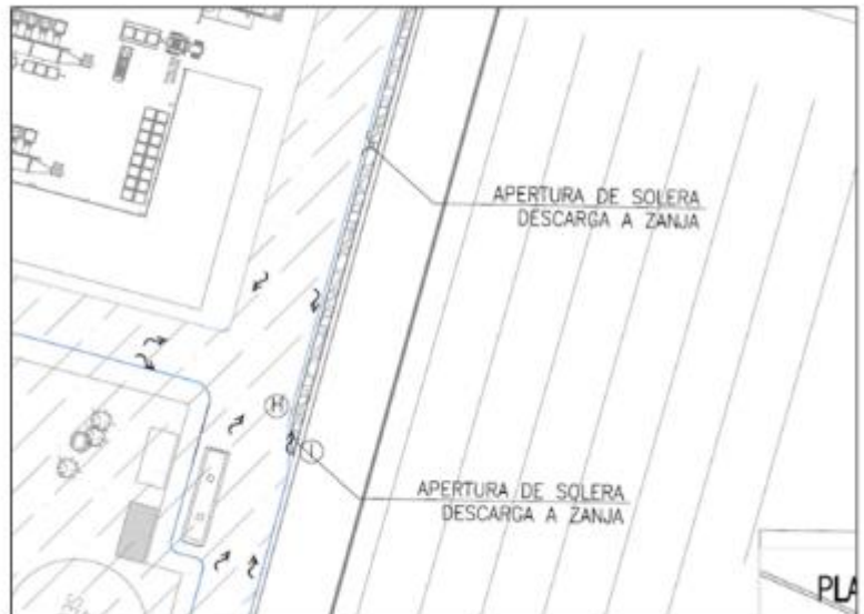
Figura 4. Apertura de solera.
