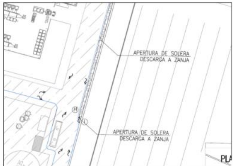
Figura 4. Apertura de solera.
