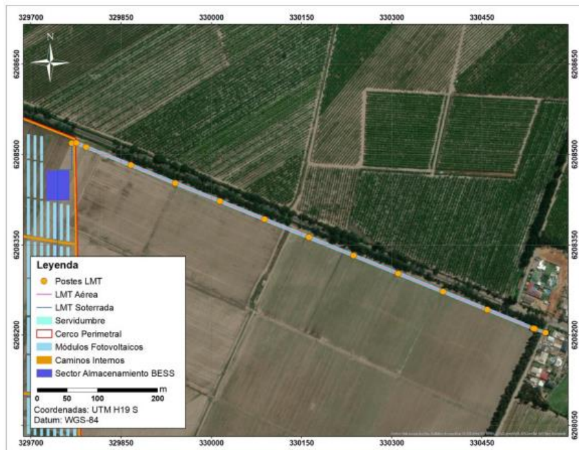
Figura 3. Línea de evacuación de media tensión.
