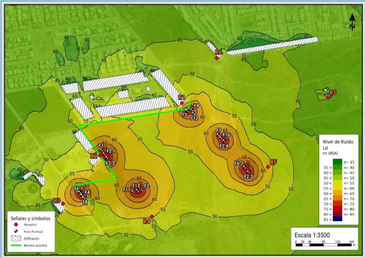
Figura 17: Mapa de ruido, Fase Construcción, con medidas de control.
