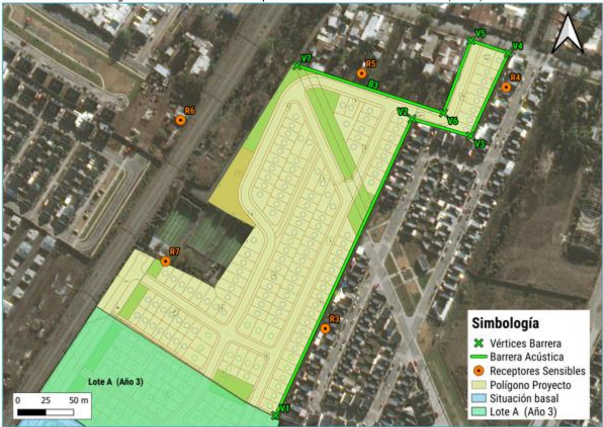
Figura 41: Barreras acústicas para fase de construcción – Lote A (año 2).
