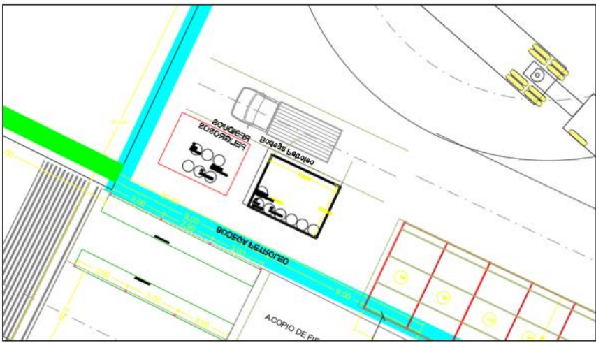
Figura 3.19. Bodega de residuos peligrosos en Instalación de Faenas (recuadro rojo).
