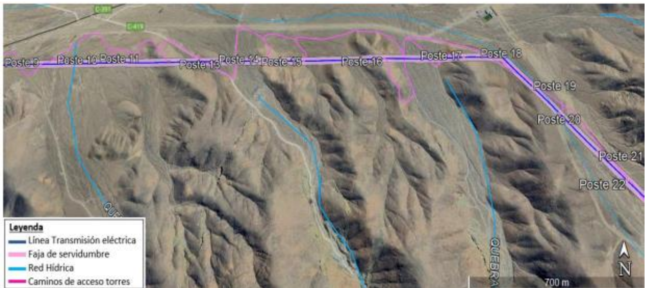
Figura 2: Postaciones de la LTE y caminos de acceso, emplazados en área de cauce natural, según antecedentes del Anexo 1.3 de la DIA en evaluación.
