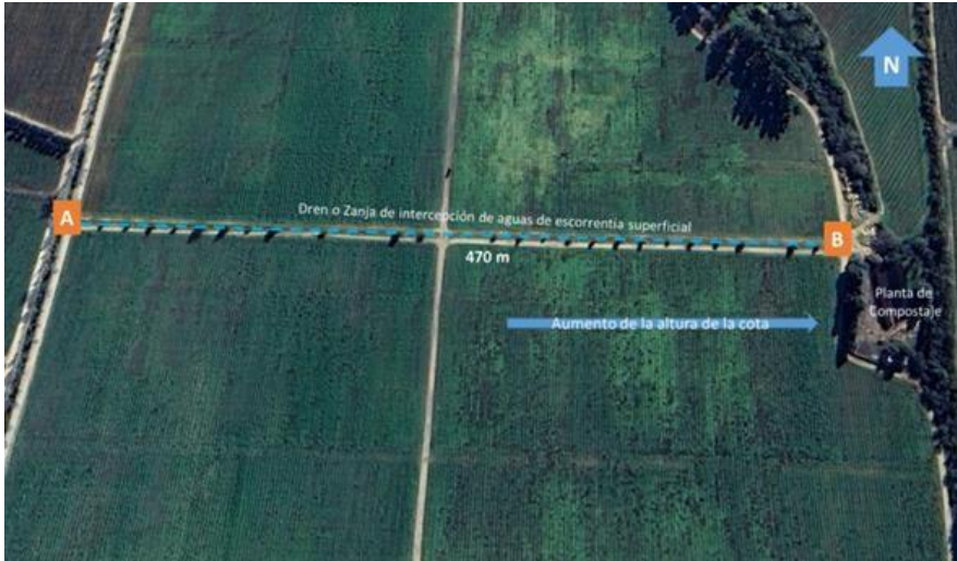
Figura 5: Ubicación del dren o zanja de intercepción de escorrentía superficial. Planta de compostaje
