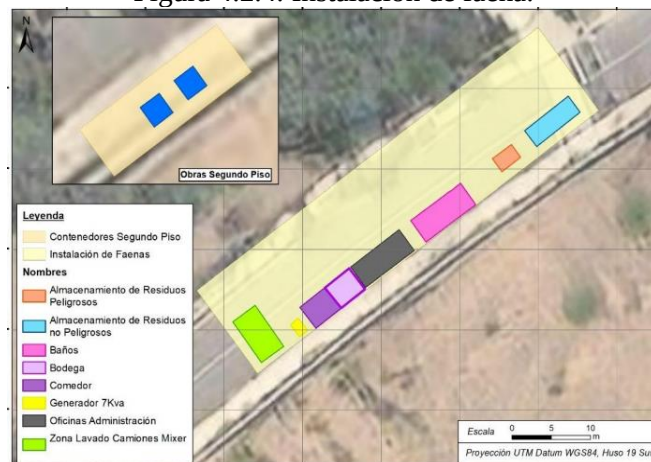
Figura 4.2.4: Instalación de faena.
