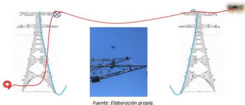
Figura 5.2.8.1.1 Proceso de instalación del cable de tendido eléctrico con dron.
