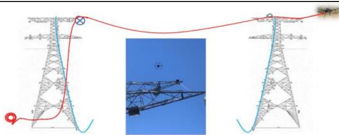
Fuente: Figura 3. Proceso de instalación del cable de tendido eléctrico con Dron, del Anexo 3 Actualización Predicción y Evaluación de Impactos, Adenda Excepcional.
