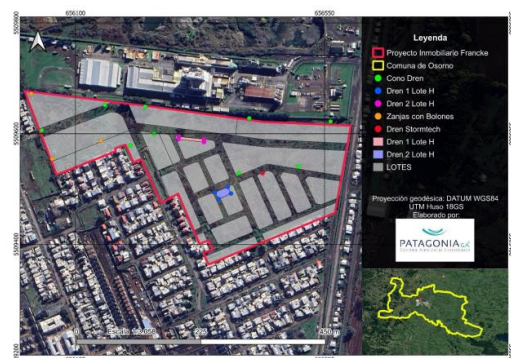
Figura 40. Localización drenes de infiltración de aguas lluvias – Proyecto
