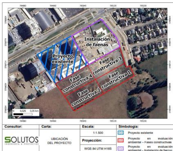
Figura. Fases constructivas del proyecto
