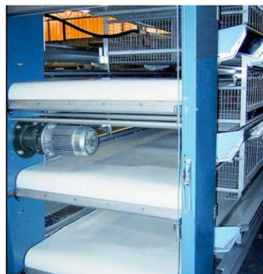
Fuente: Ilustración 5. Pabellón automático y cintas de recolección de guano, de la Adenda.
