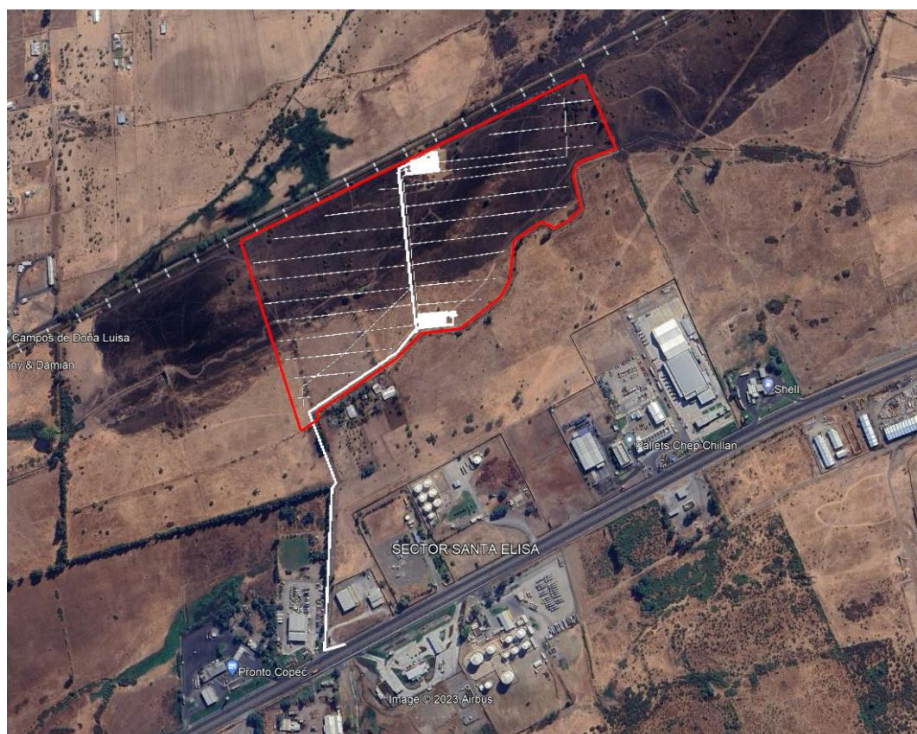
Figura 4.7.5.4.3 Dominio Campo Eléctrico superior a la norma de 5 kV/m
