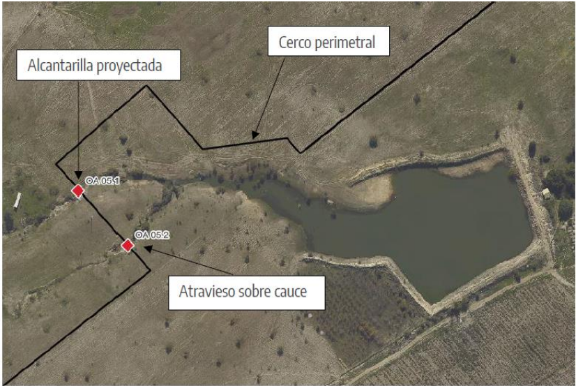
Fuente: Figura 1-70 del Anexo 3.1 del Adenda Complementaria. Esquema de obra de atraveso OA 05
