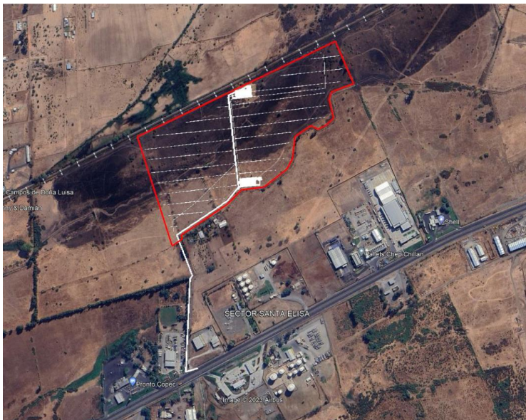
Figura 5.1.5 Dominio Campo Eléctrico superior a la norma de 5 kV/m
