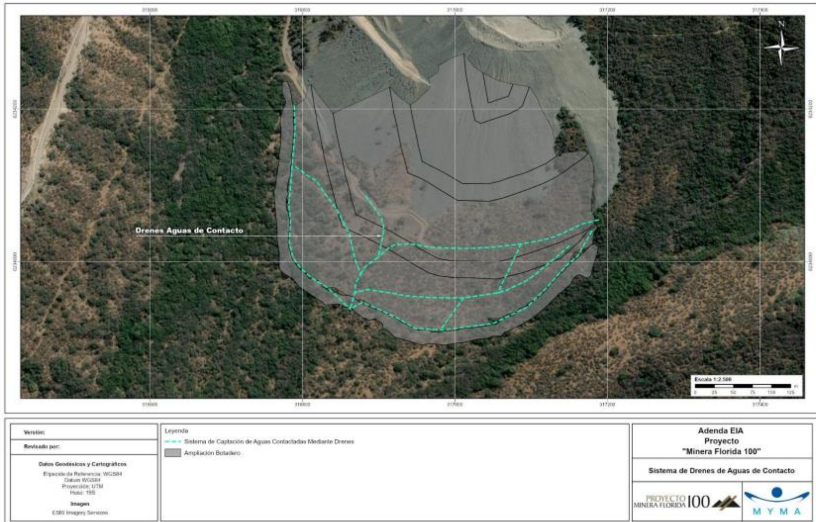
Figura 9: Sistema de drenes – Ampliación Botadero de Estériles
