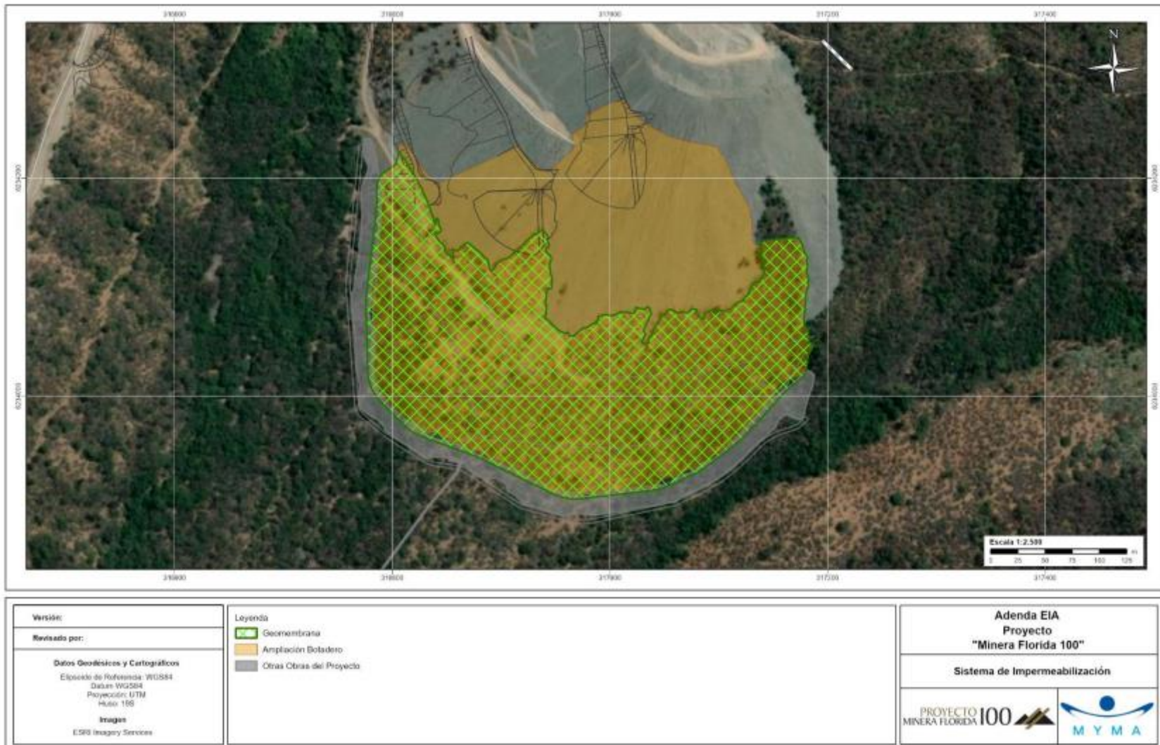
Figura 10: Impermeabilización por geomembrana – Ampliación Botadero de Estériles
