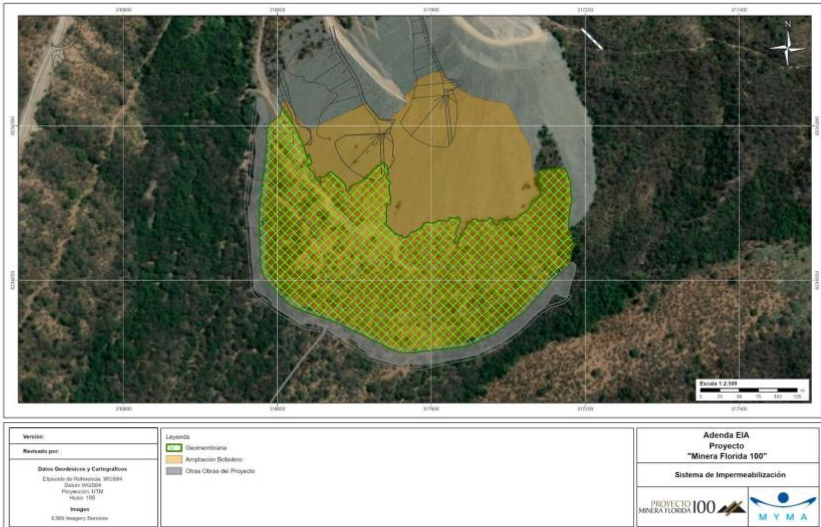
Figura 10: Impermeabilización por geomembrana – Ampliación Botadero de Estériles
