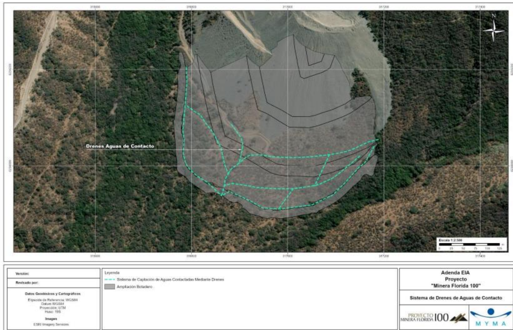
Figura 9: Sistema de drenes – Ampliación Botadero de Estériles
