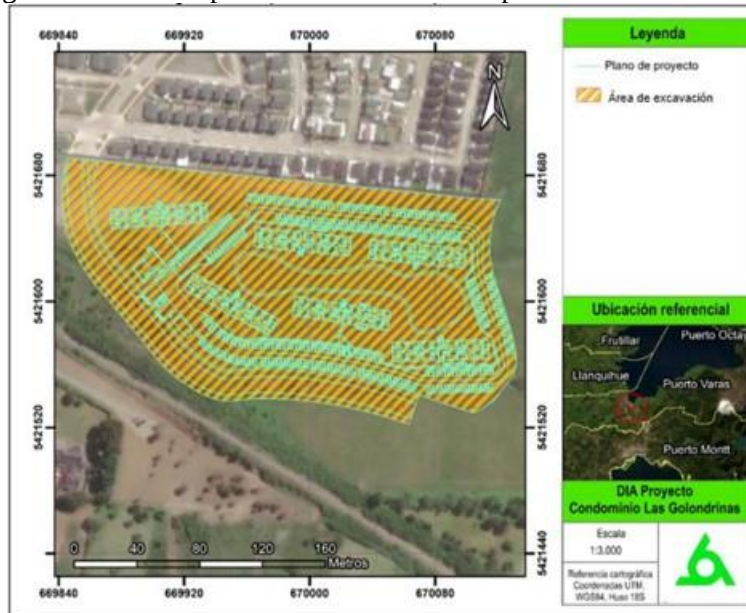
Figura 4.6.1.2.5. Superficie de excavación a profundidades variables.
