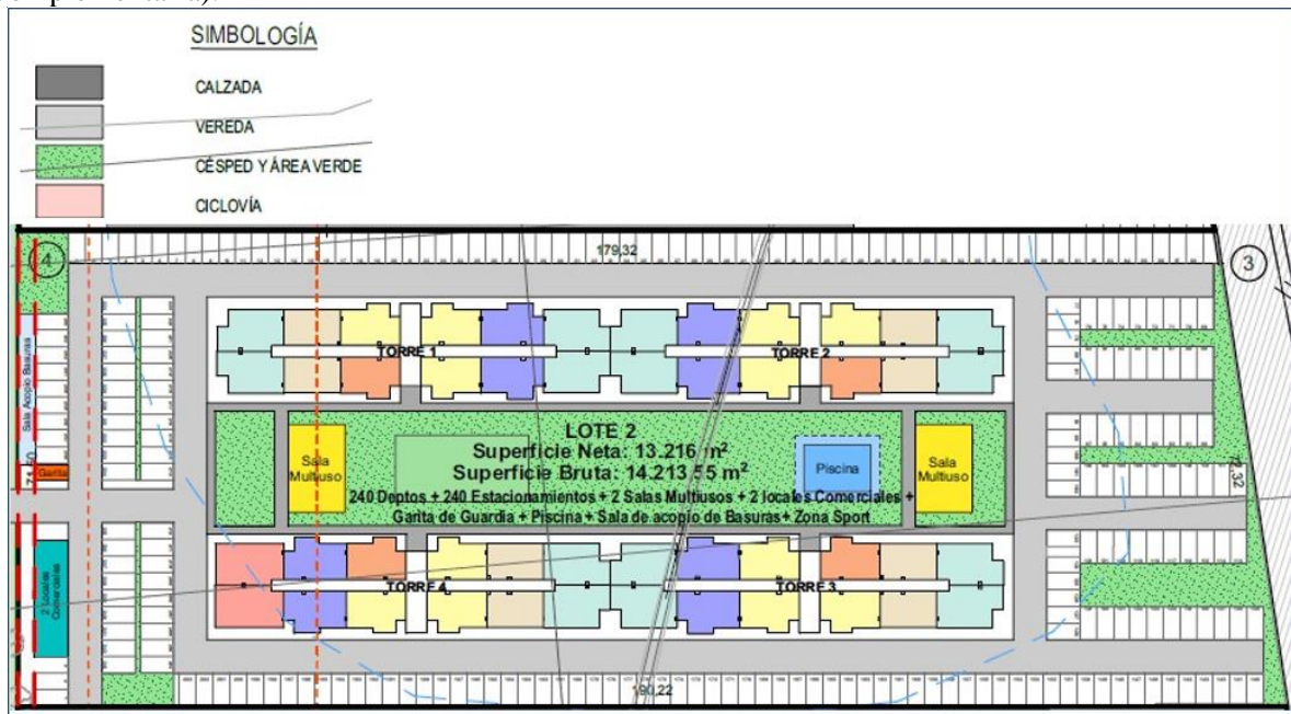
Fuente: Figura 24. Plano de planta del Lote 2 (Plano del Proyecto completo en el Anexo 9 de la Adenda Complementaria). Adenda Complementaria.
