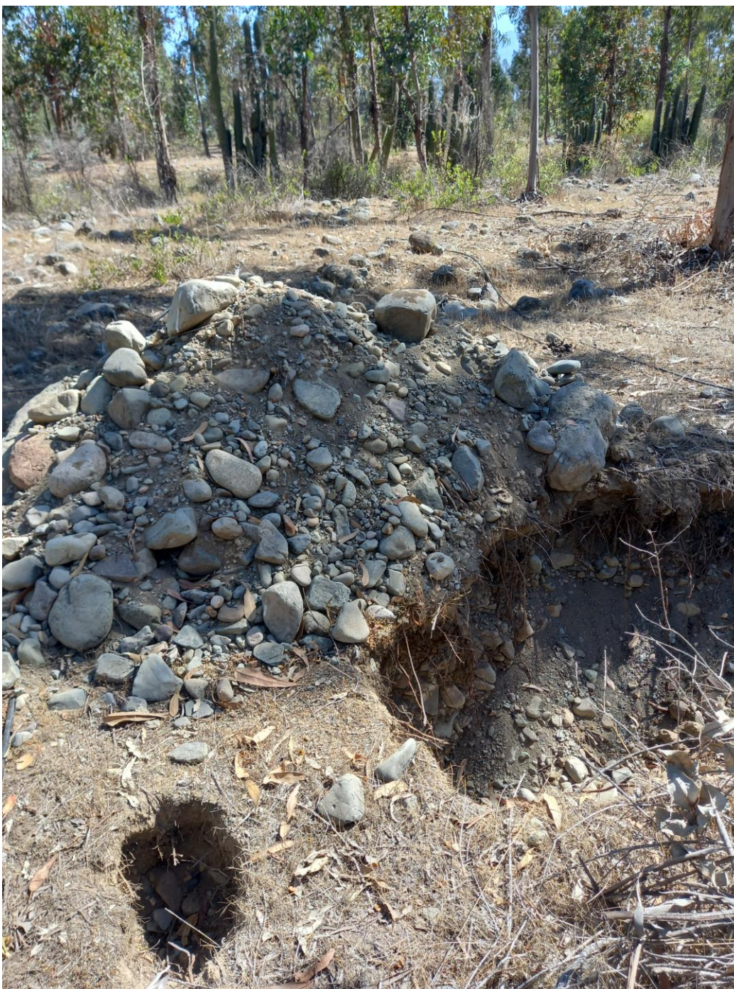
Fuente: Fotografía tomada en terreno (9 de diciembre de 2024) en la cual se muestra la escasa profundidad efectiva de la excavación en el suelo, donde se emplazará el Parque Fotovoltaico Kaban. Dirección Regional del SEA de la Región de O'Higgins
