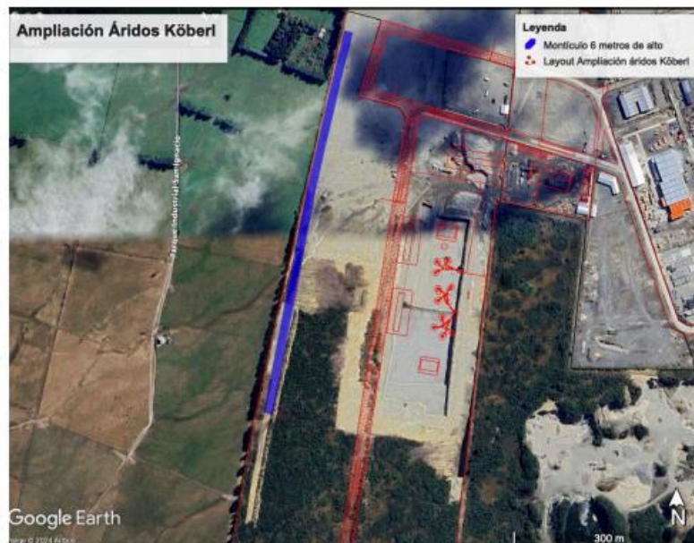
Imagen 2. Montículo a habilitar por el prouyecto el cual tendrá una superficie aproximada de 600 metros por 13 metros de ancho por 6 metros de altura.
