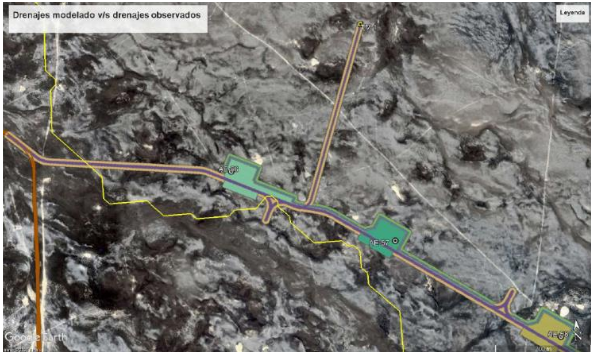
Figura 2. Drenaje modelado en amarillo, no se correlaciona con el drenaje observado por imágenes satelitales Google Earth. Drenaje modelado se ubica sobre la obra.
