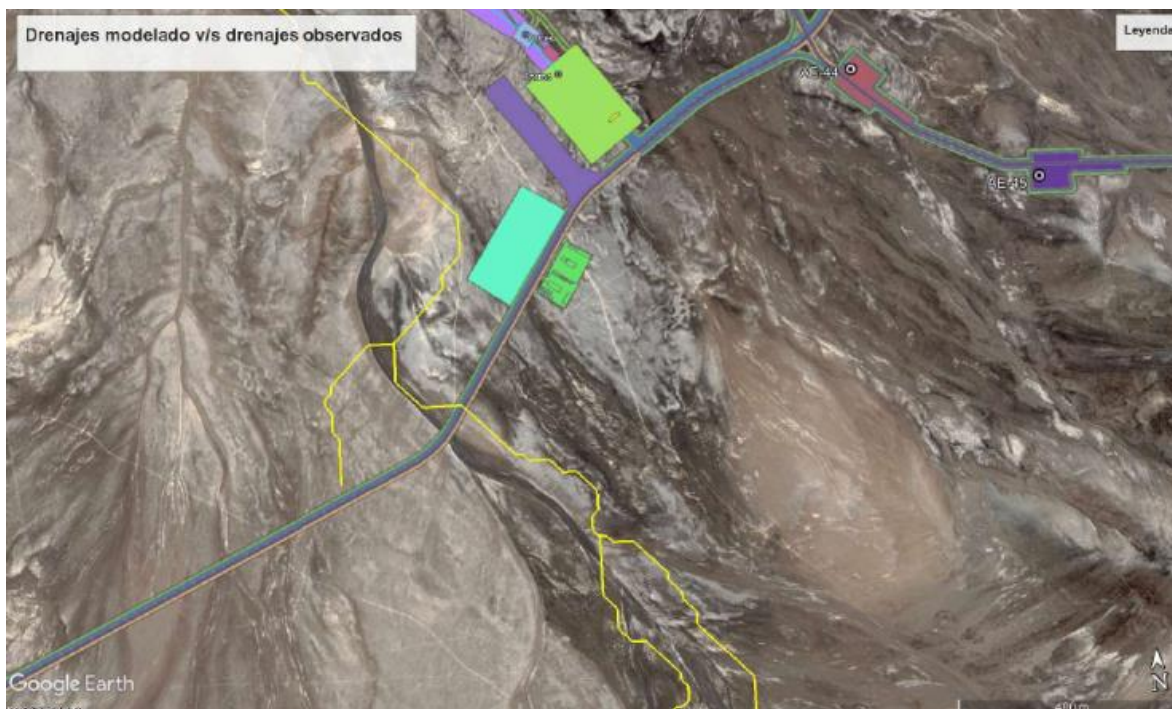
Figura 1. Ejemplos de drenaje modelado en líneas amarillas que no se correlacionan con el drenaje observado por imágenes satelitales Google Earth.
