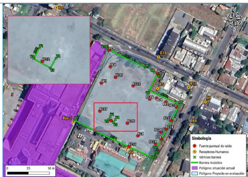
Figura 5 Barreras acústicas para fase de construcción.
