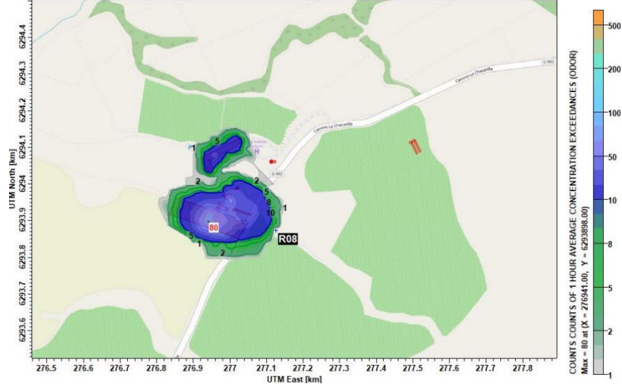
Figura 11: Isolnea de concentración de olor, hora de excedencia de 3,5 UO.
