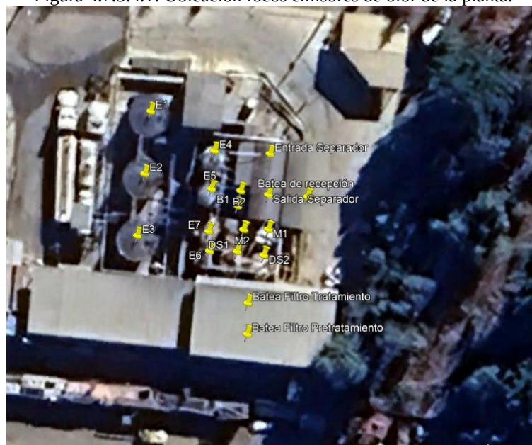
Figura 4.7.5.4.1: Ubicación focos emisores de olor de la planta.
