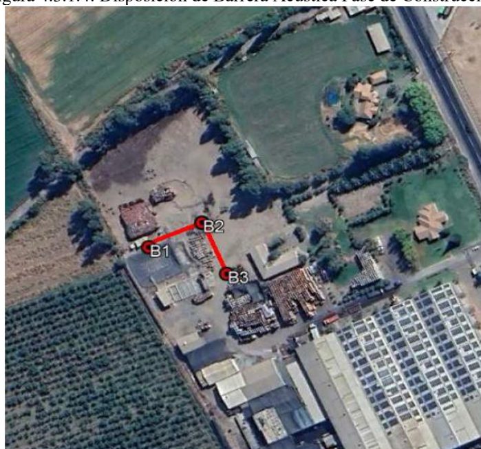
Figura 4.3.1.4: Disposición de Barrera Acústica Fase de Construcción.
