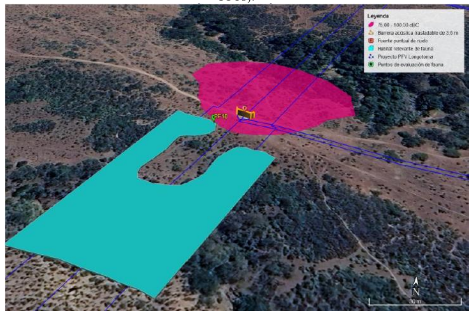
Figura 11.1.20.3: Esquema de implementación de medidas de control de ruido (Punto PF18).
