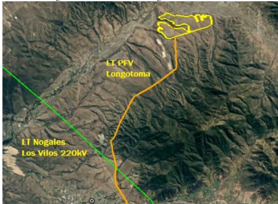
Figura 4.3.2.1: Cruce con línea Nogales Los Vilos 220 kV.
