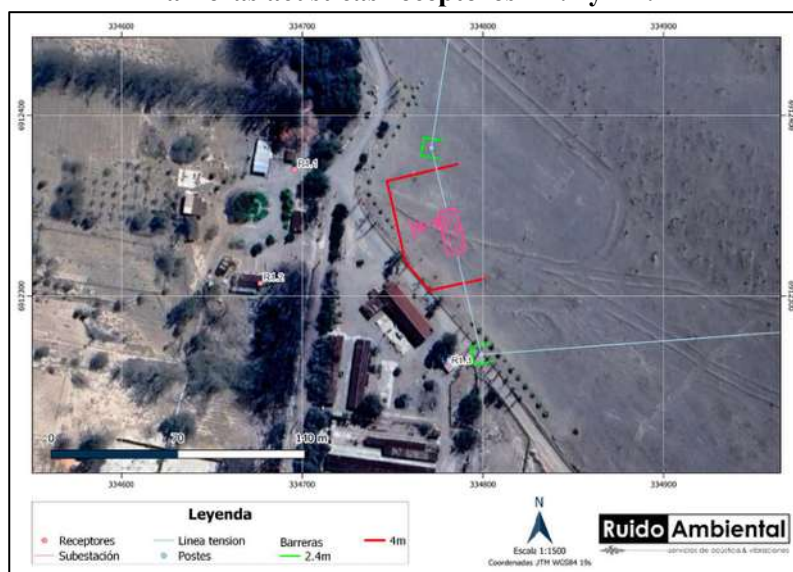
Barreras acústicas receptores R1.1 y R1.2
