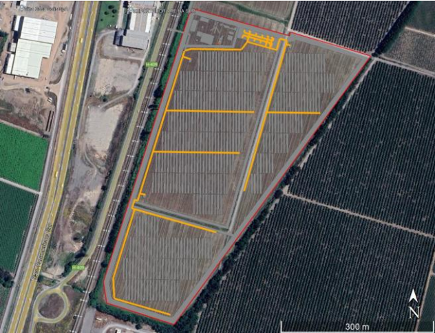
Figura 11. Zanjias o canalizaciones de interconexión
