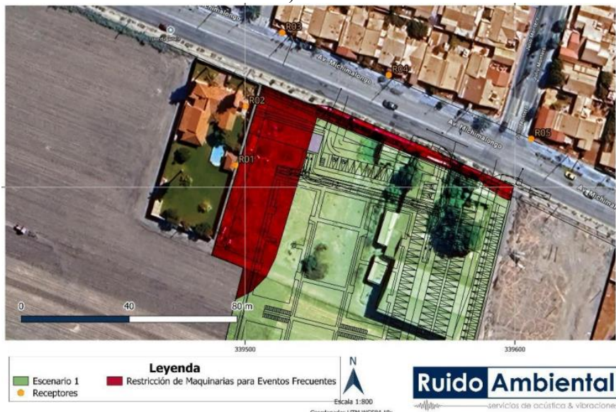
Figura 4.3.2.7: Medidas de control de vibraciones (excavadora y similares, LV = 87) Escenario 1.
