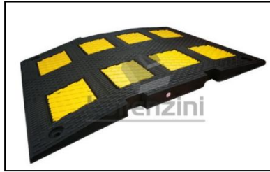
Figura 10.1.3.3. Imagen de referencial de “Lomo de Toro” o Reductor de Velocidad. Caucho vulcanizado de alta resistencia al tránsito de vehículos. Dimensiones: 500 x 600 x 35 mm
