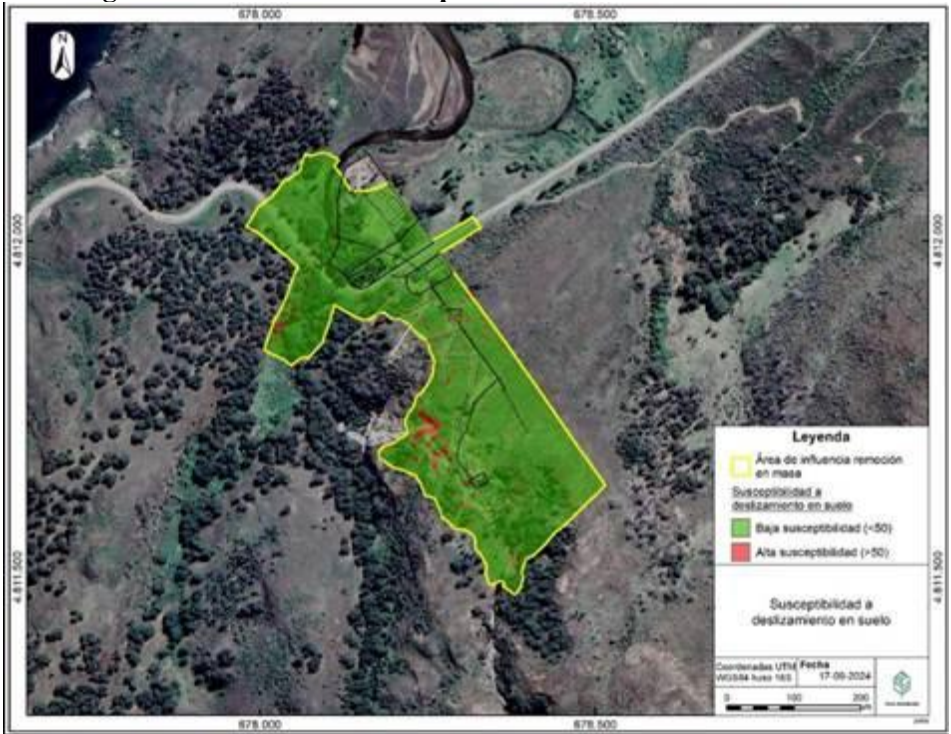
Figura 6.2.3.: Índice de susceptibilidad a deslizamiento en suelo.
