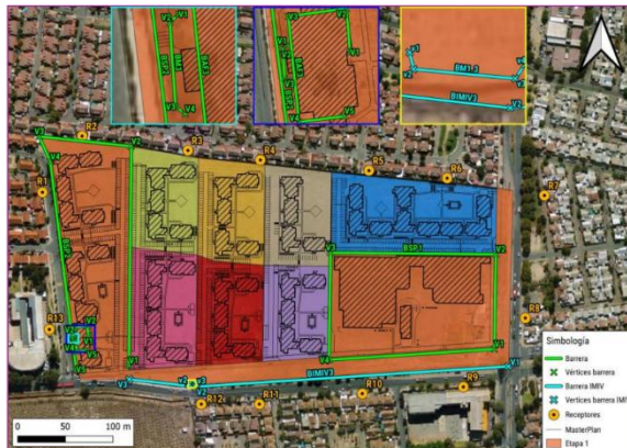
Figura 4.121. Ubicación barrera acústica subfase 1, escenario 3
