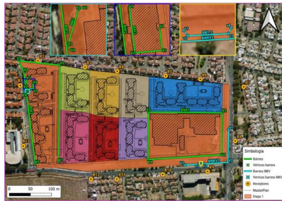
Figura 4.120. Ubicación barrera acústica subfase 1, escenario 2
