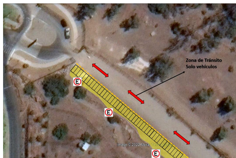
Figura 9.2.2. Esquema de demarcación y señalética
