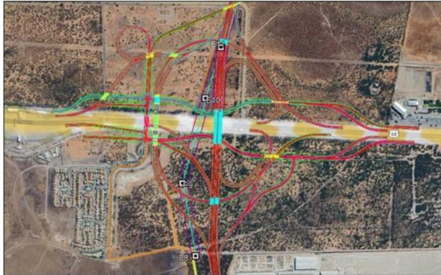
Figura N°2: Interferencias Enlace ONP - R68 y Torres de Alta Tensión E8 a E10.
