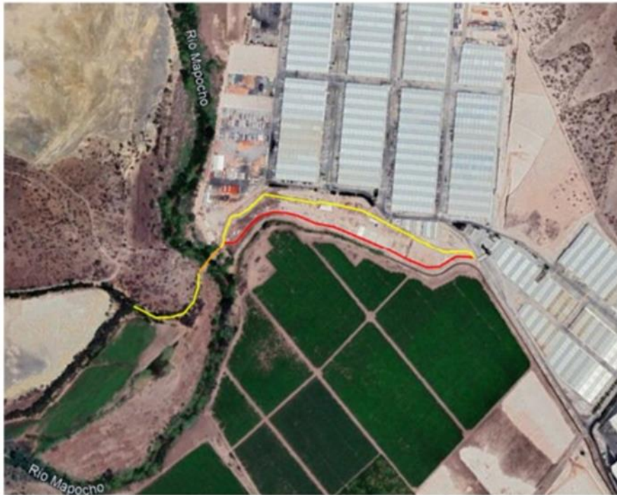
Figura 1: En amarillo trazado del canal Menichetti actualmente en uso. En naranja, paso sobre nivel de canal Menichetti por el rio Mapocho. En rojo, trazado del canal Menichetti inferido de figura 1-25 del Capítulo 1: Descripción de Proyecto del EIA.
