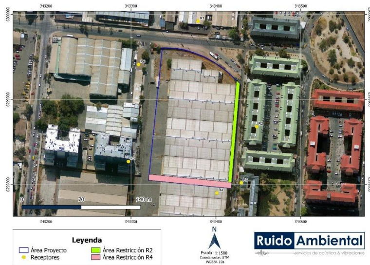
Figura 8.1.2.2: Áreas de Restricción para el uso de Rodillo Compactador – Escenario 2
